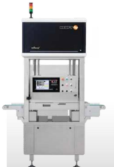
Behältern, realisiert HEUFT reflexx<sup>2</sup> ein Höchstmaß an Erkennungssicherheit. Mit wenigen Einstellparametern und automatischer Maskenadaptation vereinfacht die neueste Version der Bildverarbeitung die cGMP-Abnahme des HEUFT spotter PH. Benutzerbezogene Zugriffsrechte, regelmäßige Passwortwechsel und ein umfassendes Audit-Trail-Protokoll schützen das System vor unerwünschten Änderungen der Einstellungen und machen sämtliche Logins über dessen gesamte Lebensdauer hinweg nachvollziehbar.
