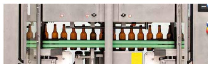
spektors von präzise arbeitenden Servomotoren angetrieben. So wird ein spezifisch einstellbarer Drehwinkel für jeden einzelnen Behältertyp realisiert; an sämtlichen Erkennungseinheiten werden die Flaschen genau richtig positioniert und ausgerichtet. Zusätzlich senkt die Servotechnologie den Anteil verschleißanfälliger Komponenten und macht – dank eindeutig reproduzierbarer Sor-
