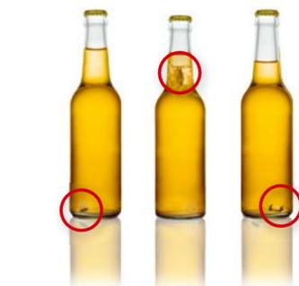
**Mit optischen und radiometrischen Verfahren realisiert der HEUFT eXaminer <sup>II</sup> XOS eine lückenlose Inline-Inspektion von Vollgut. Die leistungsstarke neue HEUFT SPECTRUM <sup>II</sup>-Technologie sorgt dafür, dass die Erkennung von Fremdkörpern geringer Dichte genauso einfach und präzise funktioniert wie die von festen – und zwar auf kleinstem Raum.**
