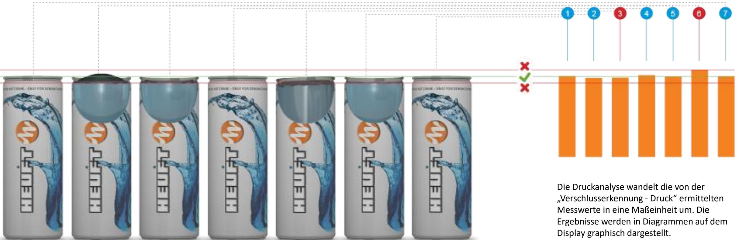
Die Druckanalyse wandelt die von der „Verschlusserkennung - Druck“ ermittelten Messwerte in eine Maßeinheit um. Die Ergebnisse werden in Diagrammen auf dem Display graphisch dargestellt.
