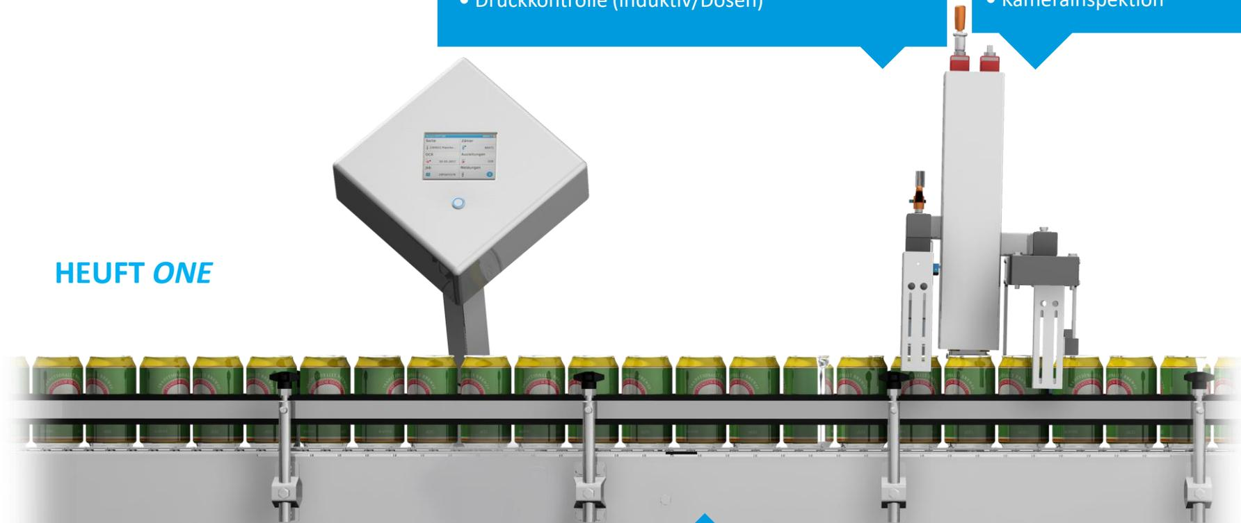
Modular und flexibel: Intelligente Inspektionsmodule einfach kombinieren.
